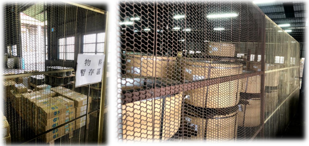
▲ 將沖壓內外片後的網狀下腳料回收製成廠區原物料防護網
