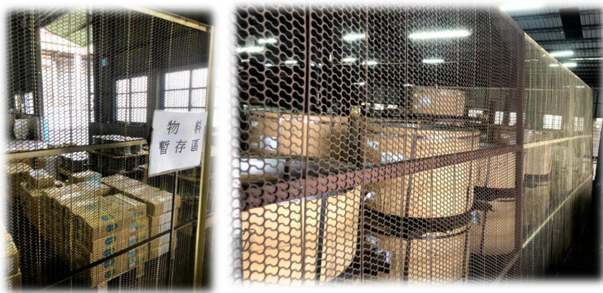
▲ 將沖壓內外片後的網狀下腳料回收製成廠區原物料防護網
